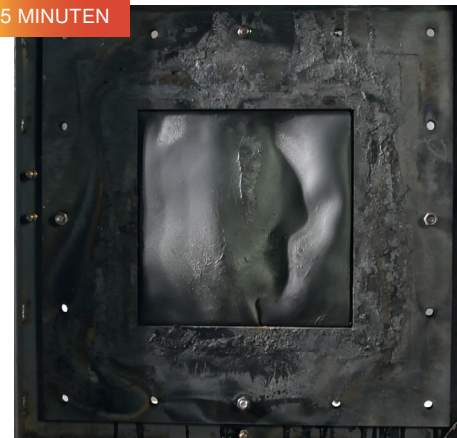
X-Protect RF0067K PA66 (3 mm) Hält direktem Feuer 15 Minuten lang stand
