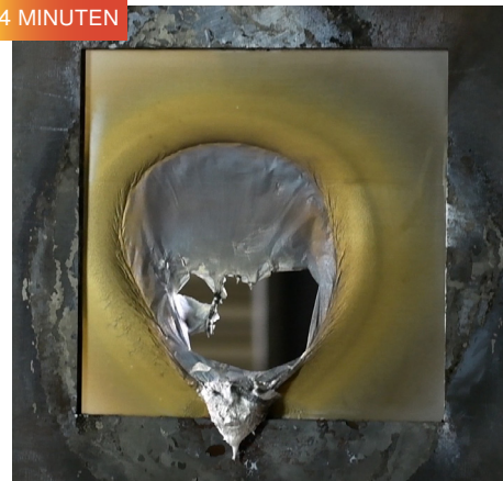
6061 T651 Aluminium (3 mm) Durchbruch in weniger als 4 Minuten
