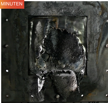
Flammenhemmendes Standard-PA66 (3 mm) Durchbruch in weniger als 3 Minuten
