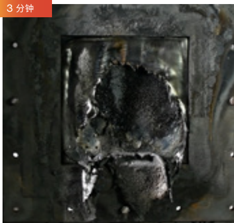
标准阻燃 PA66 (3mm) 在 3 分钟 内破裂
